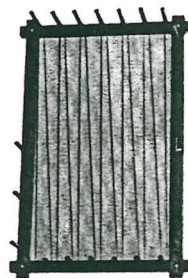
Fig. 9 Urdidor de pared
