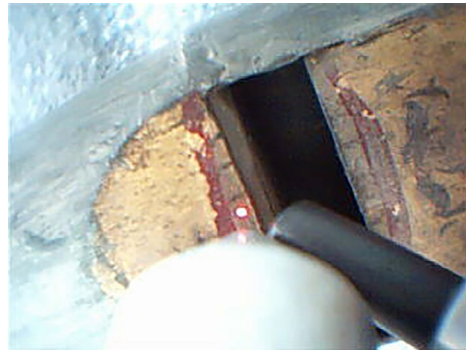
Análisis con fluorescencia de rayos X para conocer los materiales constitutivos del tubo de un órgano (fotografía de Jimena Palacios).
