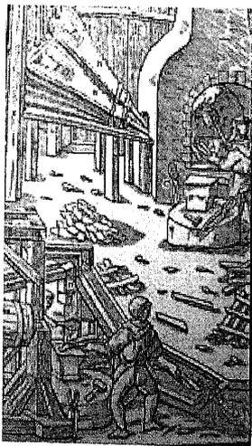
Ilustración 35 Trabajo de forja del S. XV alimentando el fuego con fuelle de cuero. Del libro "De res metallica" de Agrípa. Primer tratado sistemático de técnicas metalúrgicas. Disponible en <http://www.ccespadas.com>.
